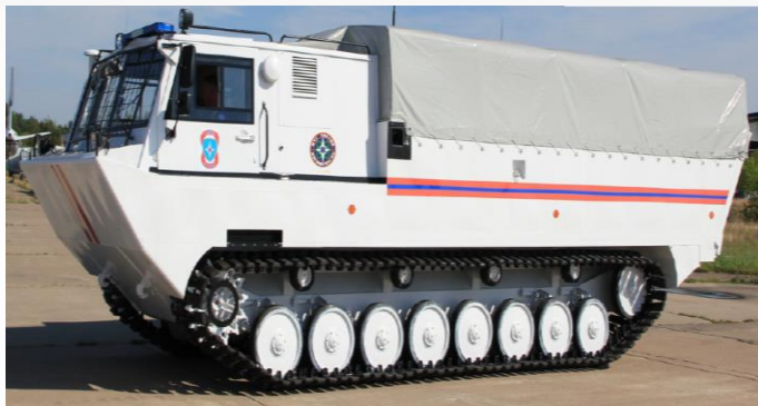
Плавающее пожарно-спасательное транспортное средство на гусеничном ходу ПТС-ПС «Тритон ЧС»
